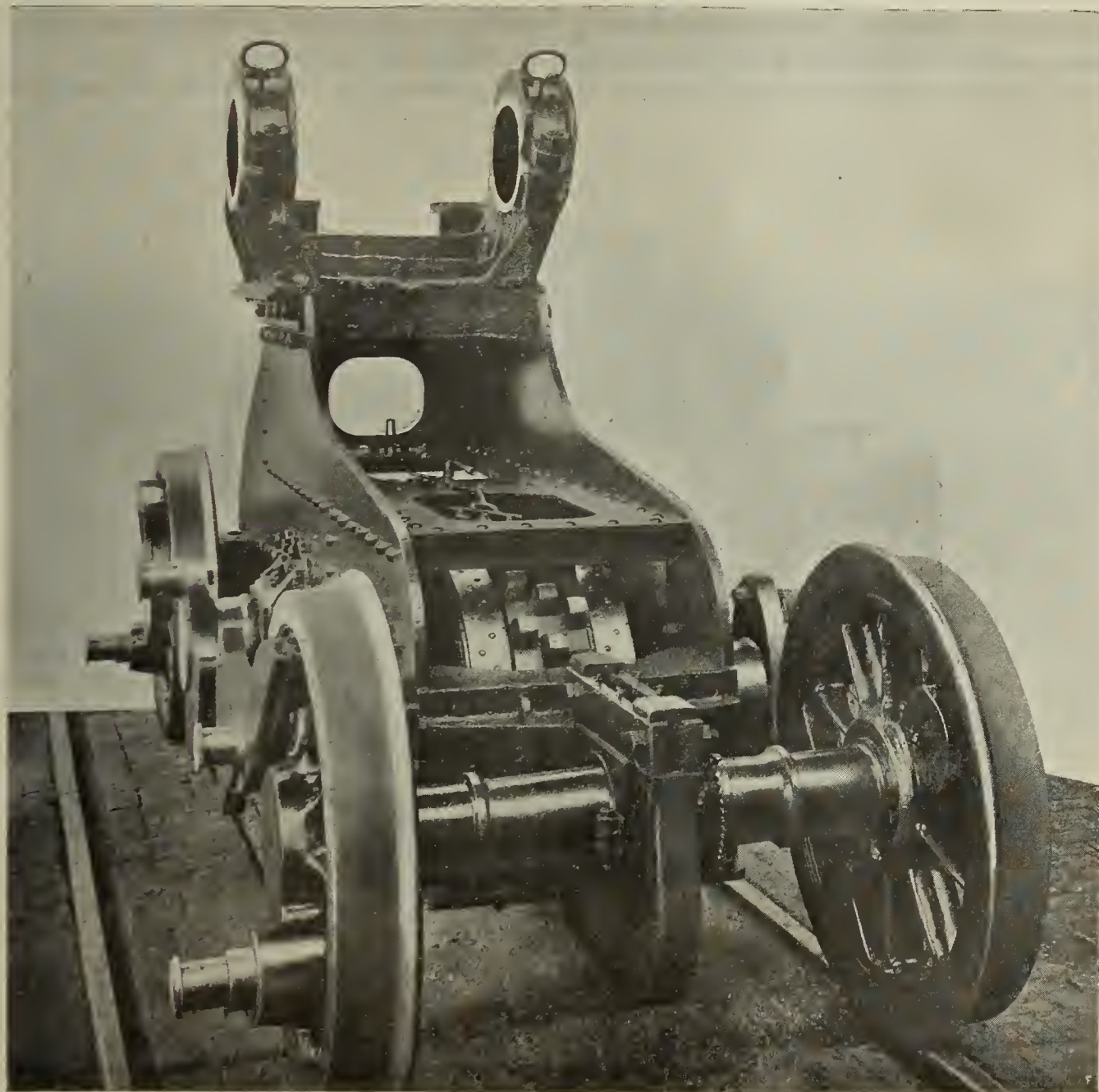
Fig. 165. — Cadre intérieur rigide de la locomotive.
