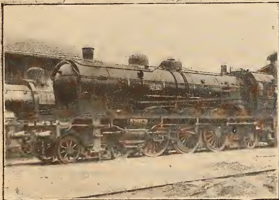
Fig. 2. Antenne sur locomotive (visible entre l'axe des roues motrices et le châssis).
